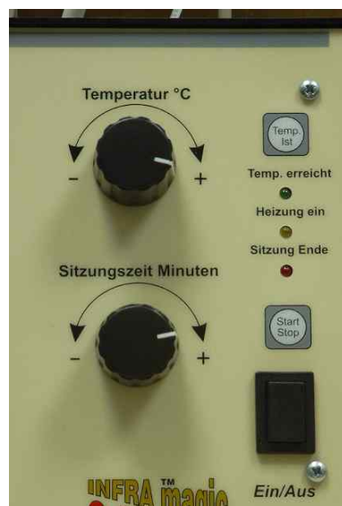
Oben links: Einstellung Solltemperatur Unten links: Einstellung Sitzungszeit Oben rechts: Umschalter Soll-/Isttemperatur Darunter: LEDs zum Zustand der Sitzung Darunter: Programm Start/Stop Taster Darunter: Hauptschalter
